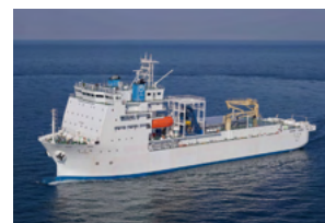
〔海底ケーブル敷設船「きずな」(総トン数8,598トン)〕
